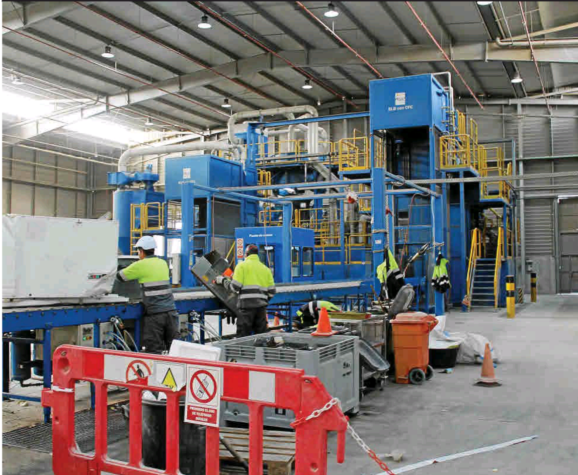
Esta máquina lleva a cabo la separación y el reciclaje de los diferentes componentes de los electrodomésticos con y sin CFC. Foto: AG.
